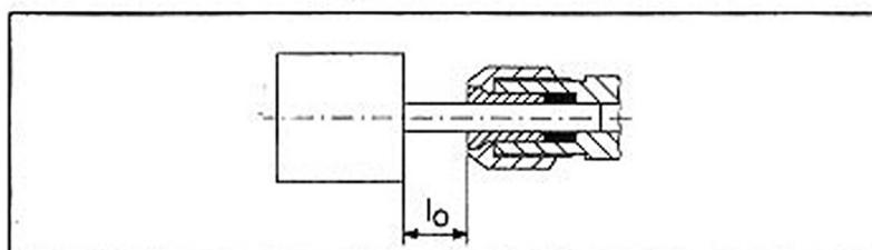
Вставьте сменный аксессуар на полную длину хвостовика (до упора) в цанговый патрон. При этом длина части хвостовика между цангой и рабочей частью аксессуара не должна быть более 8 мм.
