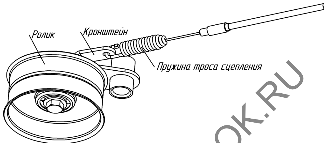
Рис.8. Схема зацепления троса сцепления с кронштейном
