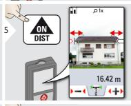
Выбрать стрелки с помощью курсорных клавиш, или нажав на сенсорный экран, и выберите нужные значения с помощью сенсорных клавиш. Рассчитана соответствующая ширина.
