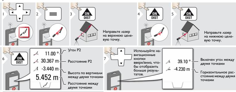
Косвенное измерение расстояния между 2 точками с дополнительными результатами. Идеально подходит для измерения длины или наклона крыши, высоты купола на крыше,...
