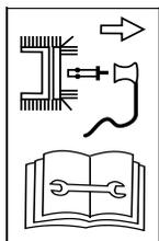
Перед началом любых работ по техобслуживанию машины (например, перед настройкой, чисткой, проверкой и т. д.) ее следует выключить и отсоединить от свечи зажигания высоковольтный кабель!
