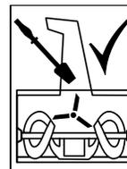
Ствол для выброса снега можно прочищать только с помощью специального инструмента для чистки.
