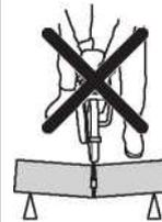
Если диск защемлен или заклинен в зоне отдачи, реактивная сила будет толкать резчик вверх и назад по направлению к пользователю вращательным движением, что приведет к серьезным или даже смертельным травмам. Будьте внимательны к возможному перемещению заготовки. Если заготовка не поддерживается должным образом и смещается во время резки, это может защемить диск и вызвать отдачу.
