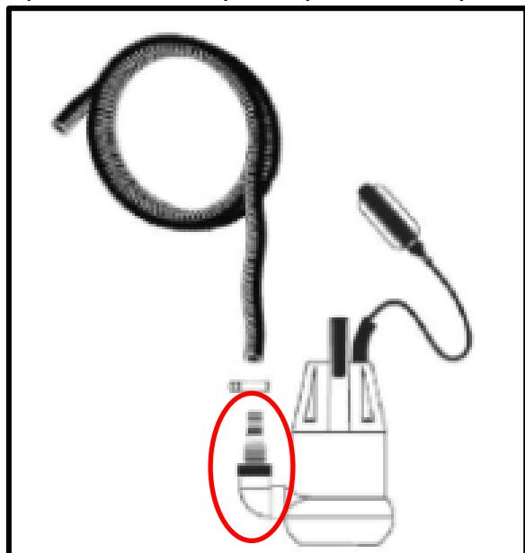
Универсальный фитинг (выделен овалом) позволяет использовать трубы/шланги диаметром 38мм (1 1/2"). Шланг рекомендуется дополнительно закрепить хомутом.
