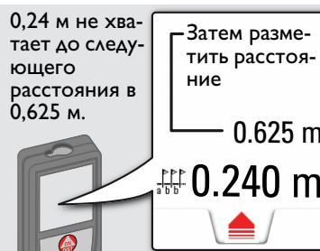
При приближении к точке разметки на расстояние менее 0,1 м прибор начинает подавать звуковой сигнал. Звуковой сигнал может быть прекращен нажатием кнопки CLEAR/OFF.
