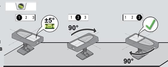
Дважды поверните прибор по направлению движения часовой стрелки на  $90^\circ$ . Следуйте инструкциям на дисплее. Выравнивание завершено после появления иконки "OK" на дисплее.
