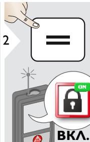
Чтобы деактивировать, повторите процедуру. Блокировка клавиатуры включена, когда прибор выключен.
