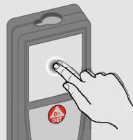
Нажмите на дисплей, чтобы открыть экранную кнопку или сделать выбор. Нажатие на значок посередине нижней линии активирует измерение расстояния или включает камеру.
