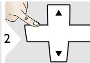
Используйте навигационные кнопки вверх/вниз, чтобы отобразить более подробные результаты конкретного измерения.
