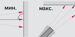
Эта функция используется для измерения диагоналей (максимальные значение) или горизонтальных расстояний до вертикальной поверхности (минимальное значение).
