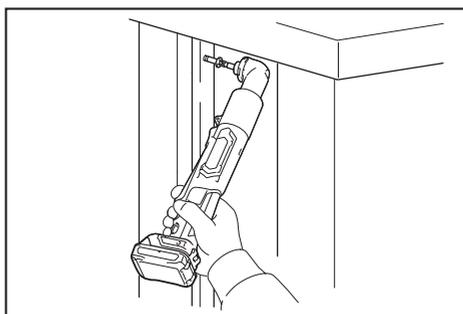
Крутящий момент затяжки зависит от множества различных факторов, включая следующее. После затяжки обязательно проверьте крутящий момент с помощью динамометрического ключа.
