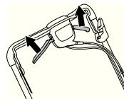
Když se pohon začne zpomalovat, seřideťte lanko ovládání spojky. Jemně seřideťte lanko pomocí seřizovacího šroubu.
