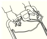
De motor wordt uitgezet door de stopschakelaar naar stopstand te schuiven.
