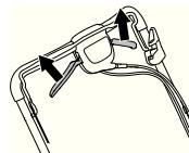
Kun vetro alkaa tuntua hitalta, kytkinvaijeria on säädettävä. Säädä hieman johtoa säätöruevin avulla.
