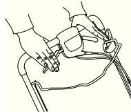
Motoren standses ved at sætte stopkontakten på stop.
