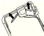
Als de aandrijving langzaam aanvoelt, dient u de koppelingsdraad aan te passen. Stel de draad nauwkeurig af met de afstelschroef.
