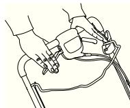
Motoru izslēdz, stop kontaktu pavirzot stop pozīcijā.
