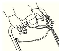
Silnik zostaje wyłączony w wyniku przestawienia włącznika w położenie "stop".
