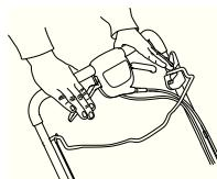
Arrêter le moteur en déplaçant l'interrupteur d'arrêt en position d'arrêt.
