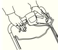
Motorn stängs av genom att stoppkontakten förs till stoppläge.
