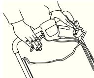
Motoren slås av ved at stoppekontakten føres til stoppstilling.
