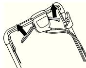
Lorsque l'entraînement ralentit, vous devez régler le câble d'embrayage. Réglez avec précision le câble à l'aide de la vis de réglage.
